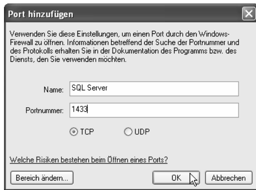
Abbildung 32.9: Öffnen Sie TCP-Port 1433 sowie UDP-Port 1434, um »von Außen« den SQL Server erreichen zu können. Öffnen Sie ebenfalls den Port für die Datei- und Druckerfreigabe, um über Named Pipes auf SQL Server zugreifen zu können (Port 445, bereits in der Ausnahmenliste vorhanden).
