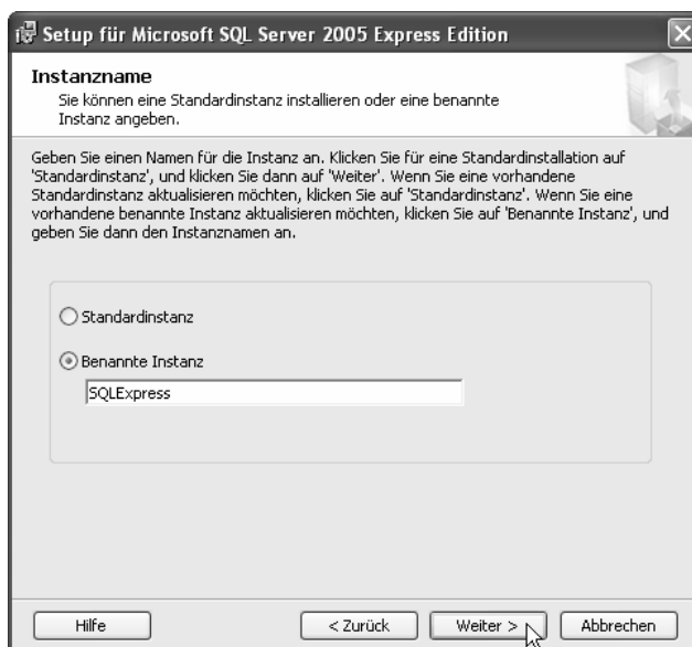
Abbildung 32.5: In diesem Dialog bestimmen Sie, unter welchem Namen die SQL Server-Instanz später zu erreichen ist
