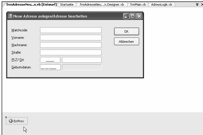
Abbildung 27.6: Eine Komponente (ein zur Entwurfzeit nicht sichtbares Steuerelement) ziehen Sie bei Bedarf ebenfalls ins Formular; der Designer legt es dann im Komponentenfach ab
