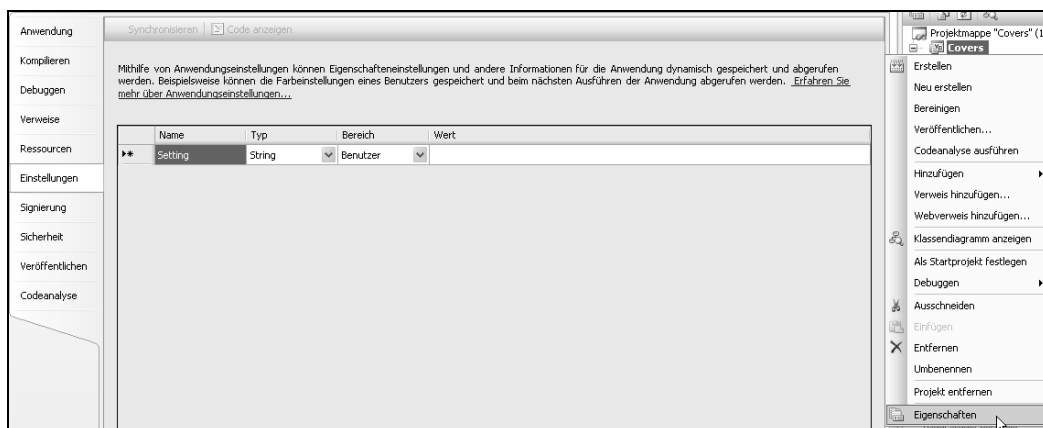
Abbildung 3.46: Den Settings-Designer (Einstellungs-Designer) finden Sie in den Projekteigenschaften, die Sie aus dem Kontextmenü des Projektes erreichen
