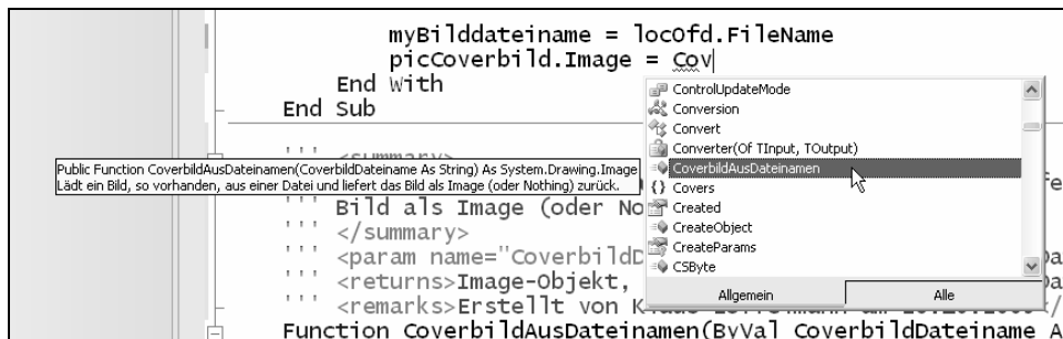
Abbildung 3.38: Wenn Sie Ihre Methoden- und Eigenschaftenprozeduren mit entsprechenden XML-Tags versehen haben, zeigt IntelliSense sowohl eine Funktionsbeschreibung ...
